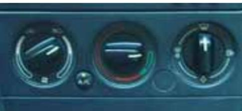
**Commande d'une climatisation manuelle :** L'utilisateur règle à partir de trois boutons de commande la puissance du débit d'air, sa température et la position des flux d'air. L'utilisateur juge s'il fait assez frais ou pas, et la climatisation ne fonctionne que s'il l'enclenche.
