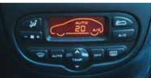
**Commande d'une climatisation automatique :** la température de consigne programmée s'affiche. Dès que le contact est mis, la climatisation (ou le chauffage) se met en marche pour la maintenir. Si la température extérieure est clémente, il faut penser à éteindre le système. Sinon, il fonctionne en permanence.
